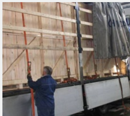
Рис. 15. Подготовка шкафов к транспортировке
