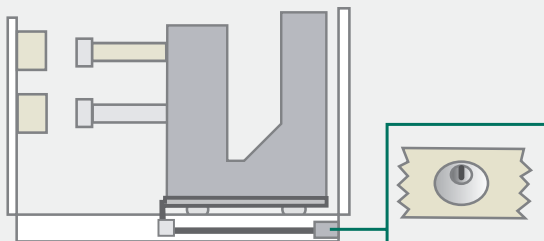
Рис. 21. Кассета заблокирована и находится в контрольном положении
